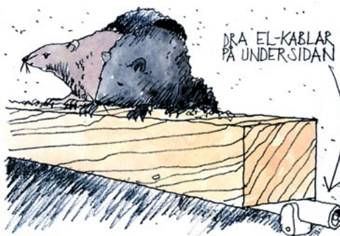
Dra elkablarna på undersidan av balkar och bjälkar så minskar du risken för råttgnagning.
